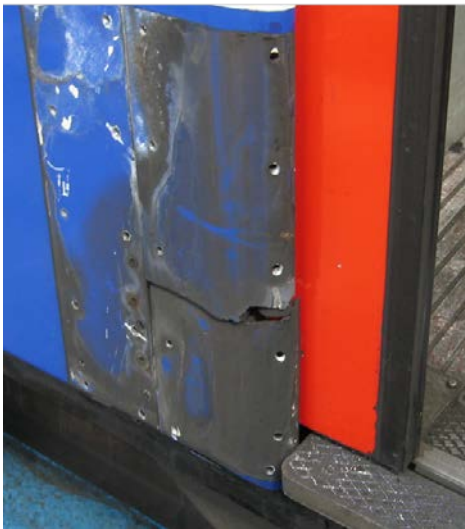
External door pillar crack
